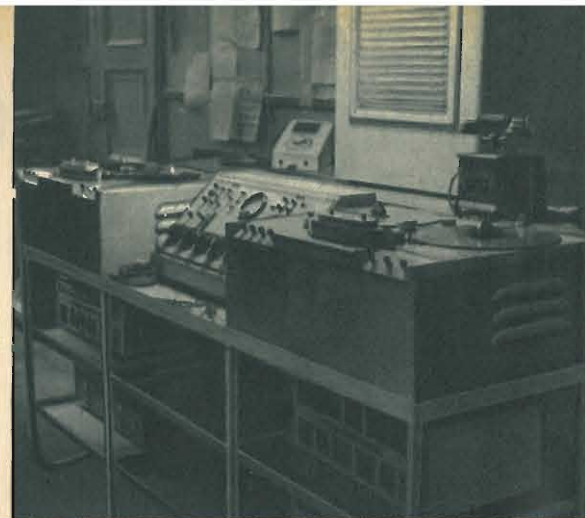
• Tavolo di registrazione del magnetofono nello studio di prova. Non occorre alcun artificio di registrazione: l'apparecchio trascrive fedelmente i suoni quali vengono modulati dall'operatore.
