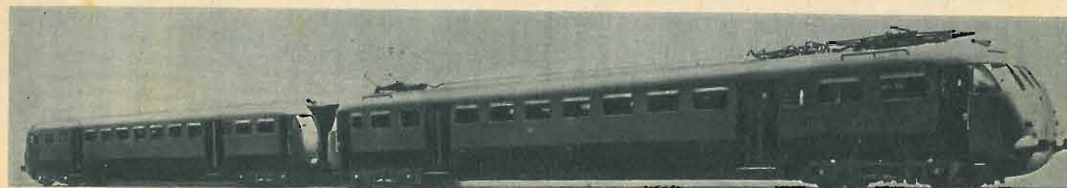
• La ALe 840, accoppiabile, è l'ultima elettromotrice costruita in Italia (Napoli): studiata prima della seconda guerra mondiale, ha tuttavia un carrello di recente progettazione. Potenza: 840 cav;
